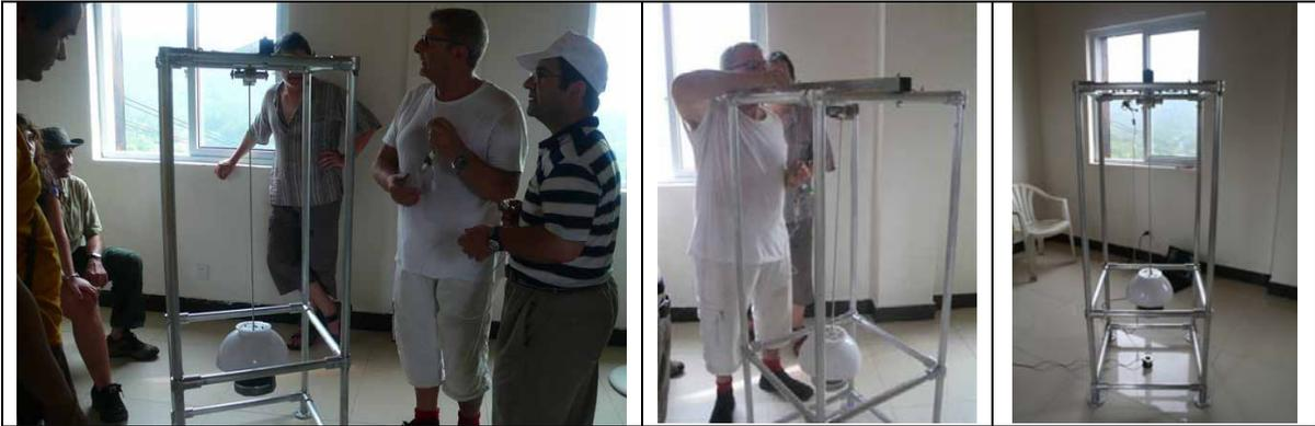
**Fotos 16, 17 y 18. Instalación del globo, del microsismómetro y de la cámara web.
