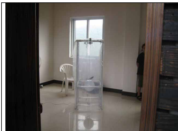
Foto 23. Penduloscopio con el capuchón de plástico. (Foto de Florencio Málaga).
