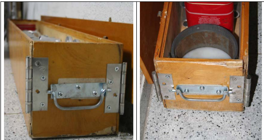
Fotos 3 y 4. La caja del bastidor reparada con medios de fortuna.
